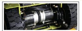
HEAVY DUTY AC DRIVE MOTORS & AXLES
